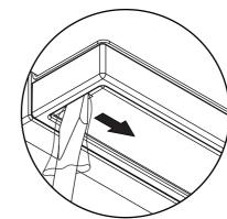
カバーを取外したい場合は、図のようにマイナスドライバーを 差し、矢印の方向に押し込んでカバーを取外してください。 ※取外しの際、製品を傷つけないようドライバーの先端を ウエスで包むなどして十分な養生を行ってください。
