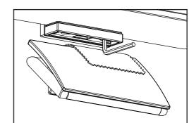
※ガラス固定ねじにゆるみが見られた場合は、 ガラスシェルフのカバーを取外し、付属の六角レンチ を用いてガラス固定ねじを締め直してください。 ※締め直しの際、周りの物を傷つけないよう 布をあてるなどして十分な養生を行ってください。
